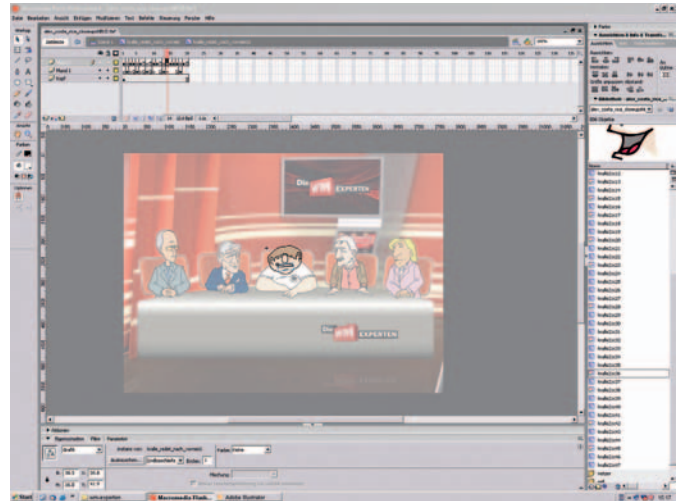
Die Flash-Animationen bestehen wie beim Legetrick aus Einzelbildern. So lassen sich beispielsweise Münder durch das Verschieben der Keyframes einfach und schnell nahezu lippensynchron animieren
